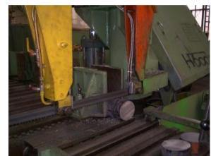
Abb.: Bandsäge AMADA H-600 mit MMKS (saeg22m.jpg)
