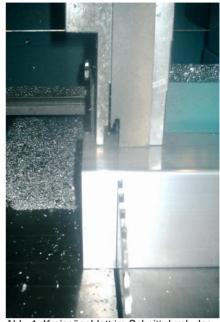
Abb. 1: Kreissägeblatt im Schnitt durch das Aluminiumprofil (saeq17m2.jpg)
